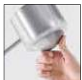
Desenvolvida para resistir a impactos físicos extremos de até 170 Joules (IK17)
